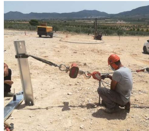
ILUSTRACIÓN 19: Ensayo de cortadura
